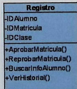
Figura # 12: Diagrama de clase para el módulo de matrícula, usuario: personal de registro
